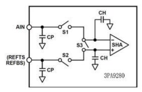
Figure 23. 3PA9280 Equivalent Input Structure
