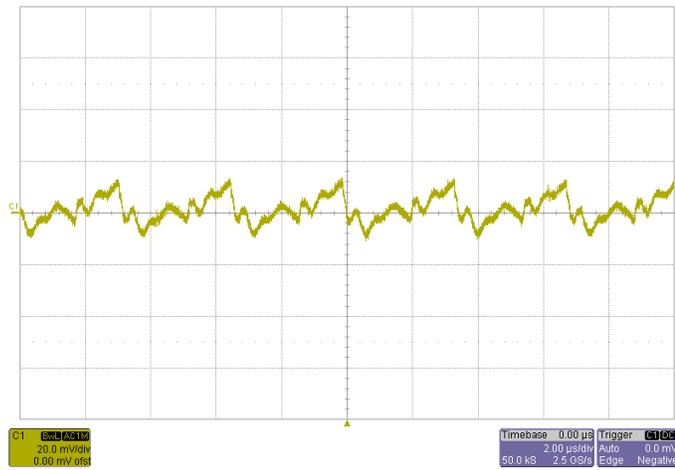
Noise  $V_{IN}=3.3V$ ,  $I_O=22A$ , 5~20MHz Bandwidth
